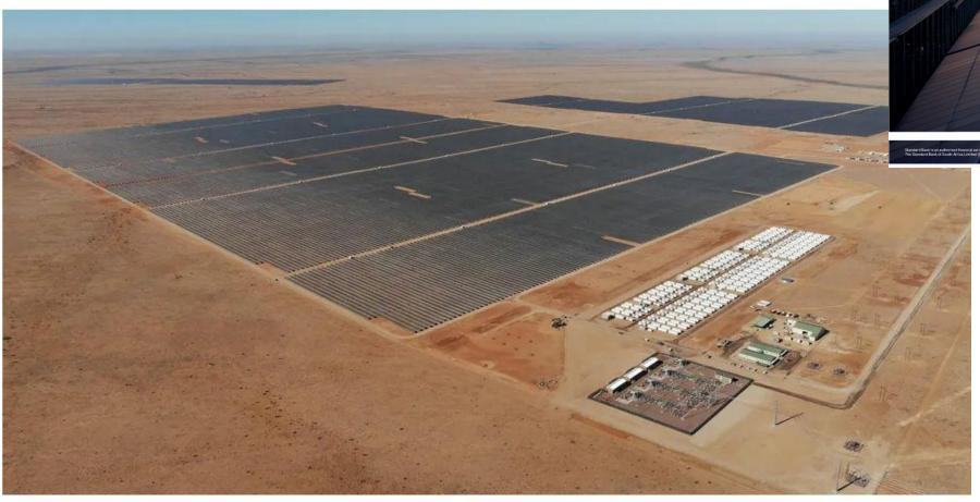
Kenhardt-anlegget dekker et område på 30 kvadratkilometer, ca. 4200 fotballbaner. Anlegget består av 540 MW solenergi, 225 MW batterier og 1,1 GWh lagringskapasitet. Det skal levere strøm i 25 år. Foto: Scatec
